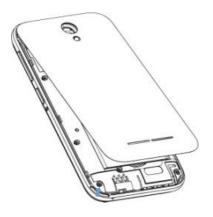
Toma la tarjeta SIM con la esquina cortada como se muestra y deslízala dentro del soporte de la tarjeta.
