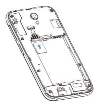
Inserta la tarjeta de memoria en la ranura con los contactos metálicos hacia abajo hasta que se ajuste en la posición correcta.
