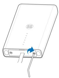
3. Reserve una longitud suficiente del cable de red, y ponche el conector RJ45.
